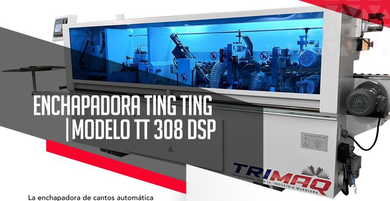
La enchapadora de cantos automática TING TING MODELO TT 308 DSP está diseñada para el revestimiento de bordes rectos de tableros para mobiliario y piezas de trabajo.
