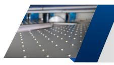
**COLCHONES DE AIRE:** todas las mesas equipadas con un sistema de aire para un movimiento ligero de los paneles.
