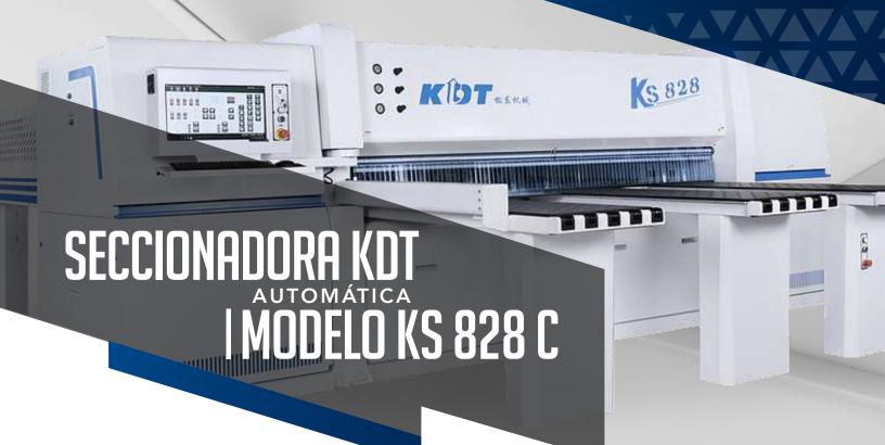
La seccionadora de corte KDT KS-828 C está diseñada para cortar paquetes de materiales de placa (DSP, MDF, tablero de fibra, etc.), tanto revestidos como naturales. La máquina ha demostrado ser buena, tanto en la producción de muebles sobre medida como en las fábricas que producen muebles en serie.
