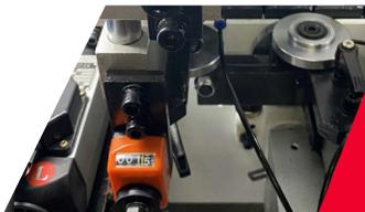
**UNIDAD DE PULIDO:** La unidad pule la parte acabada del borde. Obteniendo un acabado limpio y delineado sobre el canto.
