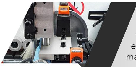
**RASCADOR DE CANTO:** La unidad está equipada con 2 cuchillas que eliminan una capa delgada del borde, obteniendo una superficie uniforme, eliminando las marcas de las cuchillas, haciendo un ajuste preciso.
